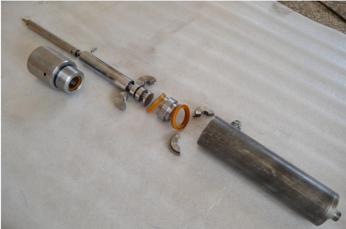
شکل ۱۲ (نمونه انفجاری جک هیدرولیک)
